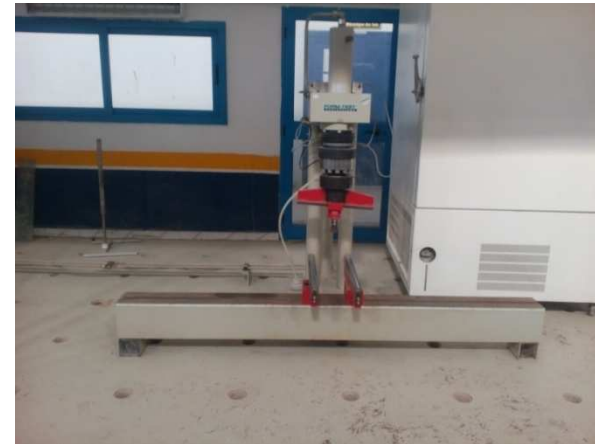
Presses pour béton (50 T) et poutres (15 T)
